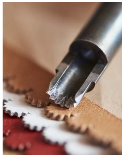
Détail d'un emporte-pièces demi-rond en zigzag servant à la découpe des dentelles en cuir ornant les courroies. Cet outil a été fabriqué spécialement par un mécanicien de précision ancien collègue de Grégory © Jean-Baptiste Morel
